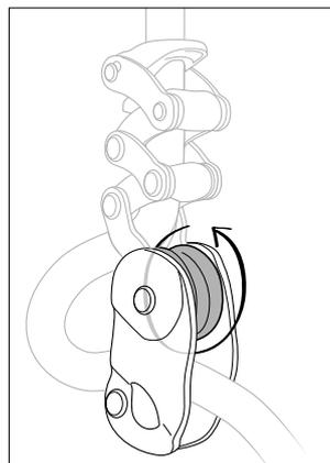
• Überprüfen Sie den Zustand der Seilrolle (Kratzer, Deformationen, Korrosionserscheinungen, Fremdkörper usw.).
