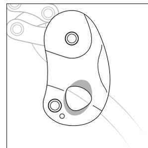
• Überprüfen Sie den Zustand des Körpers und der Niete (Kratzer, Deformationen, Risse, Korrosionserscheinungen, formschlüssige Verbindung usw.).
