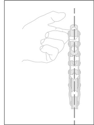
• Überprüfen Sie, dass sich die Kette zum Blockieren des Seils ungehindert ausziehen und vollkommen zusammenfallen lässt. Falls nötig mit Wasser und Seife reinigen und etwas schmieren (z.B. mit Graphitpulver).
