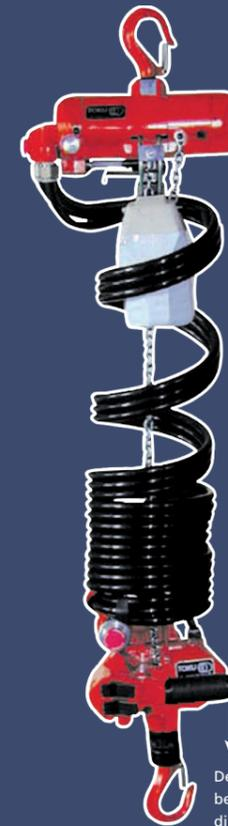
Der Hängetaster befindet sich direkt am Unterhaken
