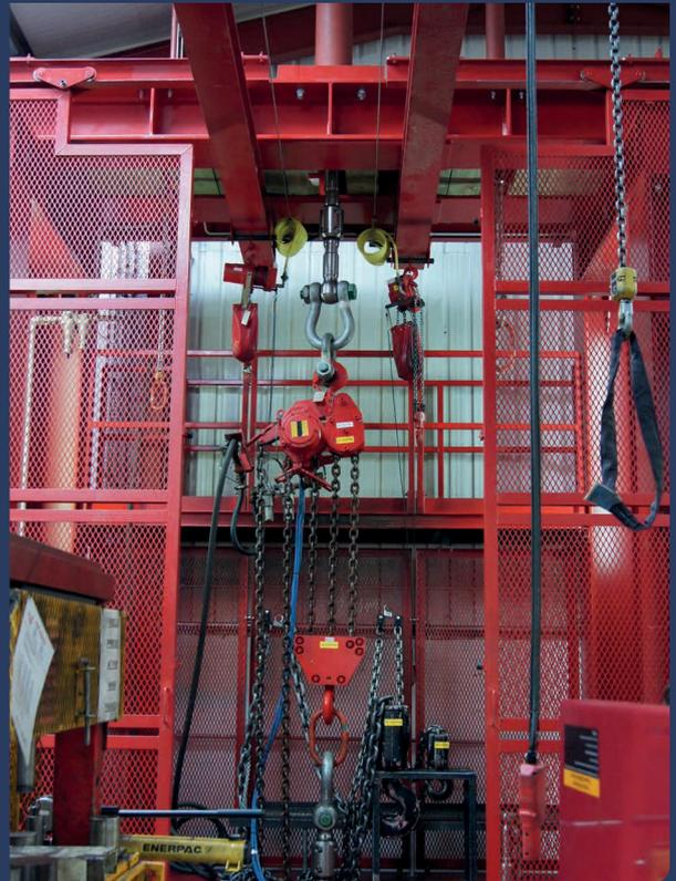
In unserer Fachwerkstatt benutzen wir einen vollständig ausgerüsteten dynamischen Prüfstand. Dieser Prüfstand ist nach der Europäischen Norm NEN - EN 818 kalibriert und zertifiziert.
