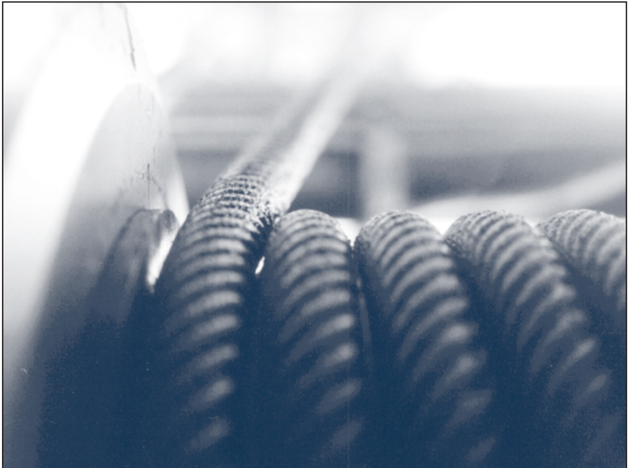
Bild 44: Unter dem Einfluß eines Ablenkwinkels wird das Drahtseil gegen seine Nachbarwindung gezogen. Die Außendrähte werden an der Berührungsstelle beschädigt.
