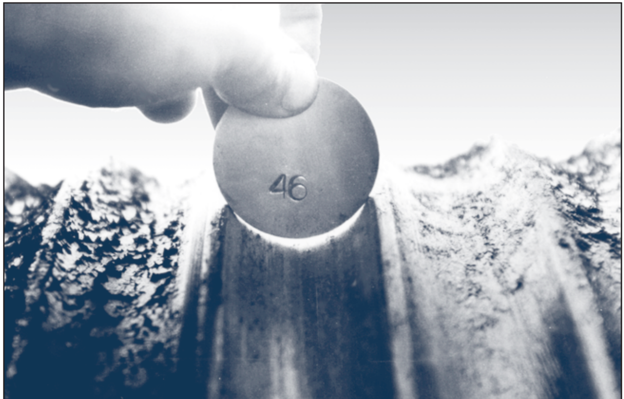
Bild 43: Zu enge Seilrille
