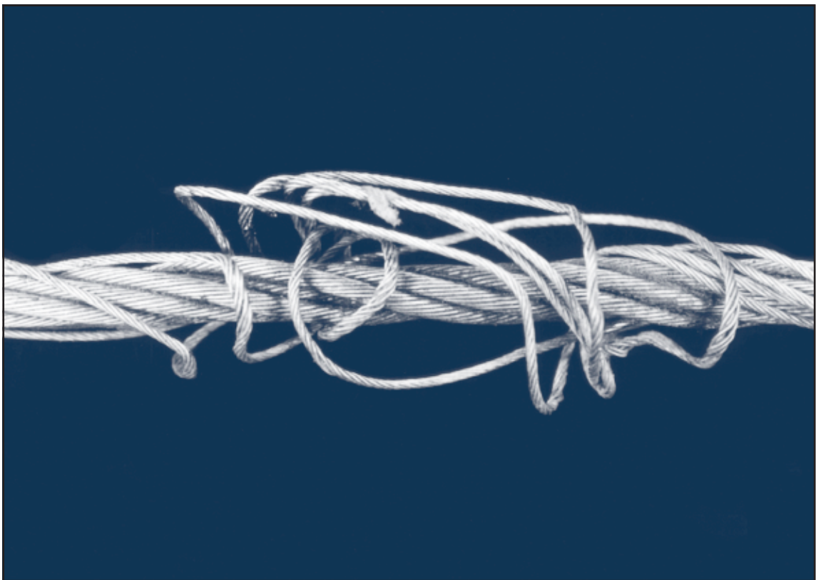
Bild 38: Längenüberschuß der Innenlitzen, verursacht durch Zudrehen des gleichen Drahtseils
