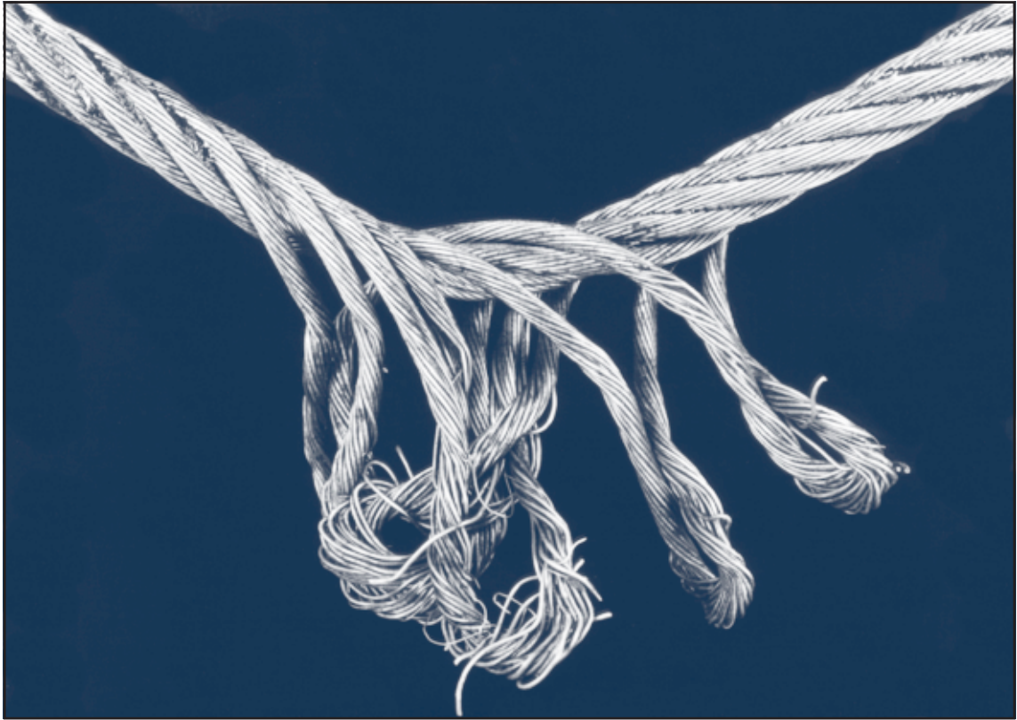
Bild 37: Längenüberschuß der Außenlitzen, verursacht durch Aufdrehen des Drahtseils
