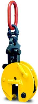
Der YALE Blechgreifer TBS mit kardanischer Aufhängung kann aus der Horizontalen aufrichten, aus der Senkrechten ablegen oder bei seitlichem Anschlag über die Kante anheben. Durch die Gleitschrägen der Schwenköse liegt immer eine ausreichend hohe Klemmkraft vor. Hierbei reduziert sich die Tragfähigkeit entsprechend dem untenstehenden Traglastdiagramm.
