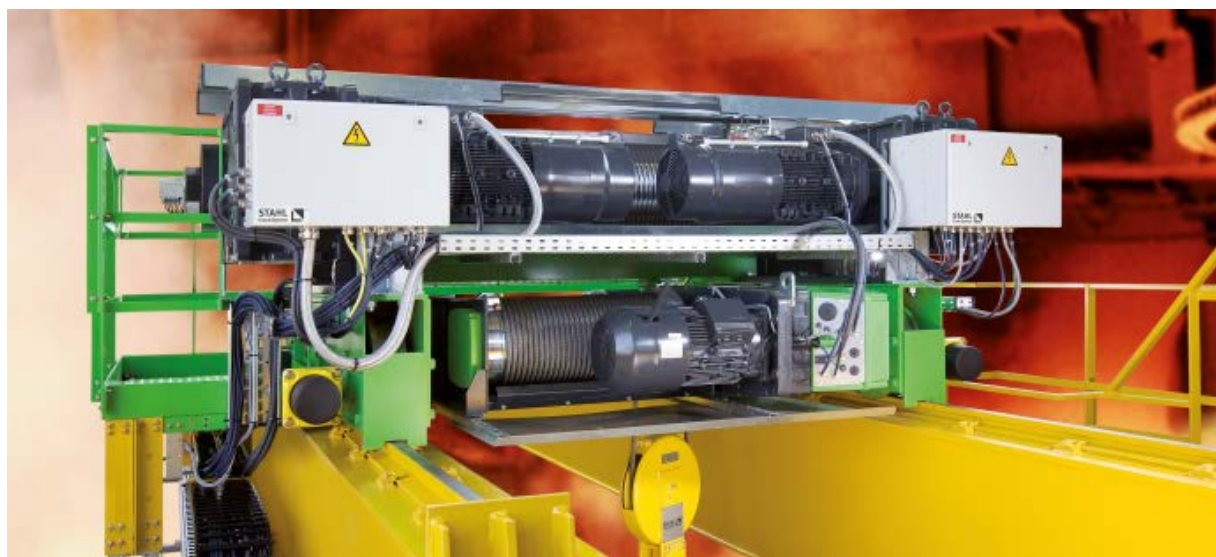
Ausführung mit einem Seilzug SH als Hilfshub
