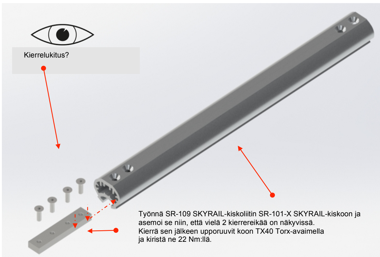
Kuva 2 SR-109- kiskojen yhdistimen asennus
