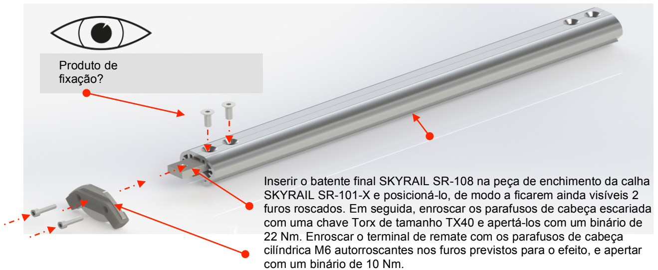
Fig. 3: Montagem do batente End Stopper SR-108
