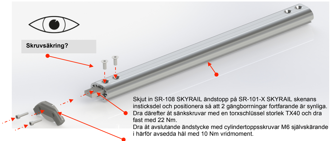
Fig. 3: Montering av ändstopp SR-108
