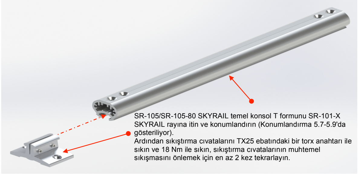
Res. 1 Temel konsol SR-105 montajı
