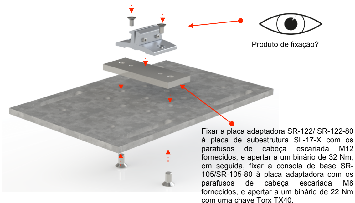
Fig. 6: Montagem da consola de base SR-105 na placa adaptadora SR-122 para placas de subestrutura SR-017
