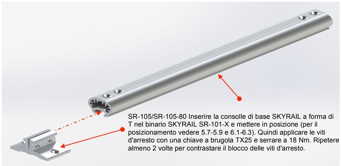
Fig. 1 Montaggio consolle di base SR-105
