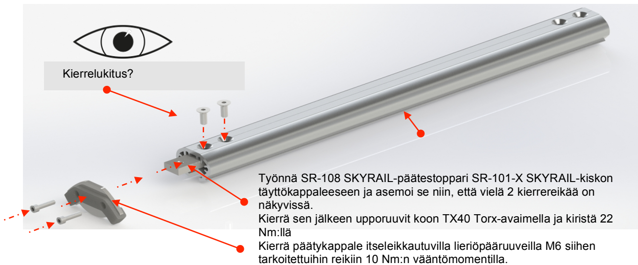
Kuva 3: SR-108-päätytulpan asennus
