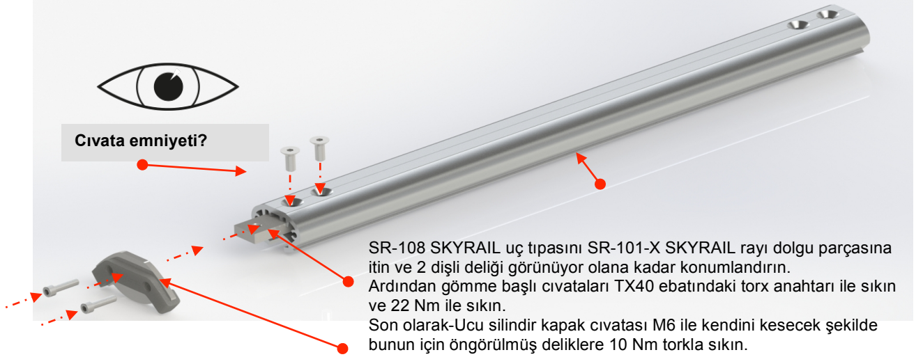
Res. 3: Nihai Durdurucu SR-108 montajı
