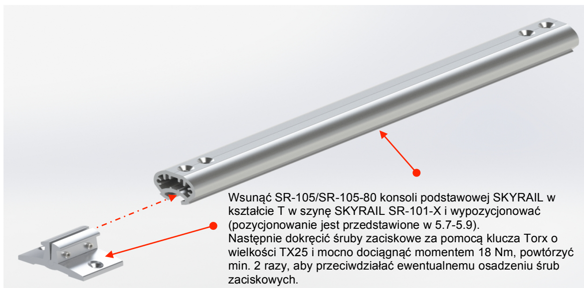
Rys. 1 Montaż konsoli bazowej SR-105
