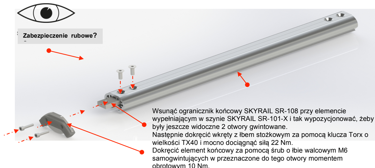
Rys. 3: Montaż stopera końcowego SR-108
