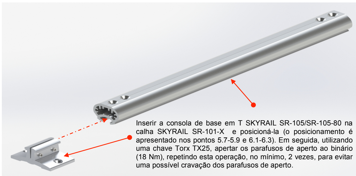
Fig. 1 Montagem da consola de base SR-105
