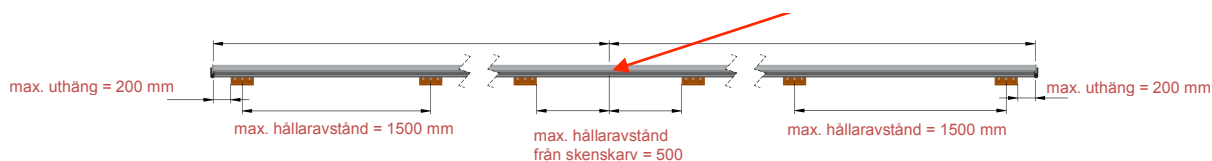
Fig. 6: Uppbyggnadsvariant med SR-105 max. 500 mm från skenskarv
