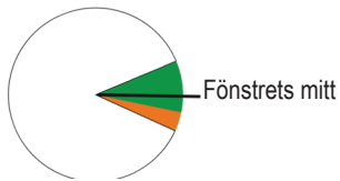
Bild 7 - Inspektionskriterier för indikatorn för bromsslitage
