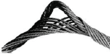
Illustration 18, Protubérances sur l'âme, indiquant des charges par à-coups
