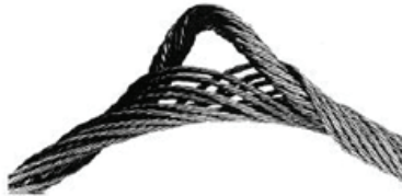
Figura 10, Abultamiento del núcleo, indicación de daños por cargas
