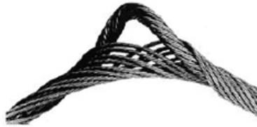
Afbeelding 10, uitsteken kern, wat op schokbelasting duidt
