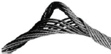
Figura 10, Saliências no núcleo, que indicam cargas de choque
