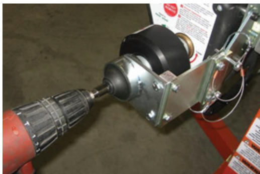
Figur 11 viser kombinationen af 4:1 gearreduktionsdrev med overbelastningskobling for at muliggøre arbejdspositionering ved brug af en højere hastighed og lavere drejningsmoment, hvis ønsket.
