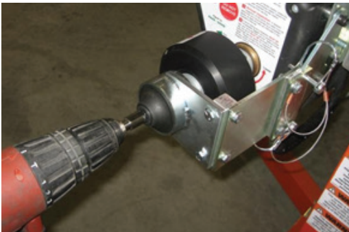
Afbeelding 11, overbrengingsverhouding van de aandrijving van 4:1 met overbelastingskoppeling
