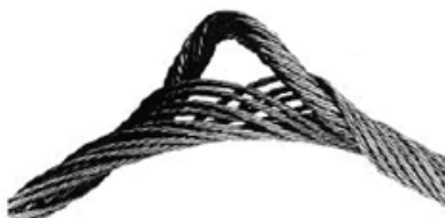
Bild 10 - Utstickande kärna, indikation på stötbelastning
