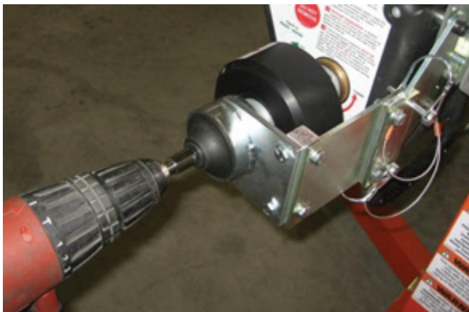
Kuva 11, 4:1-alennusvaihekäyttö ja ylikuormituskytkin
