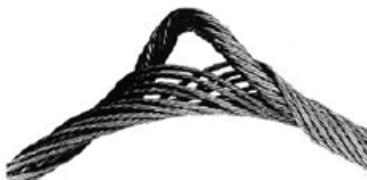
Figur 10, Kjernegjennomslag, Indikerer sjokkbelastning
