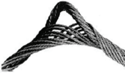
Abbildung 18 Kernausbuchtung, deutet auf Schockbelastung hin
