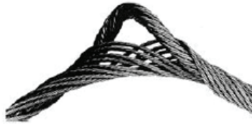
Figura 18, Fuoriuscita dell'anima, indicante un carico d'urto
