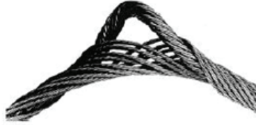
Şekil 17 Şok Yükleme Yösteren Çekirdek Çıkıntısı
