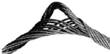
Figur 10. kernefremsporina. som indikerer chokbelastning
