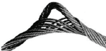
Kuva 10, Sydämen ulostyöntymä, merkinä shokkikuormituksesta
