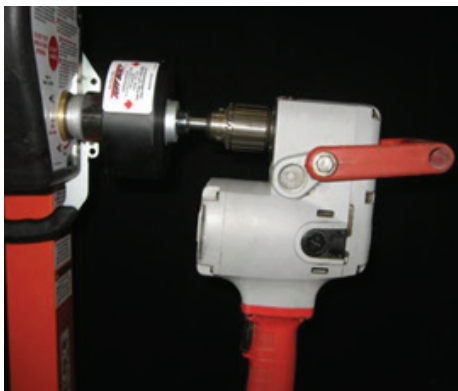
Illustration 9, Entraînement 1:1 avec limiteur de couple
