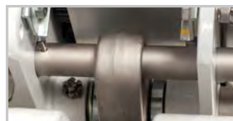
Vernickelter Aufhängungsbolzen und Verbinder
