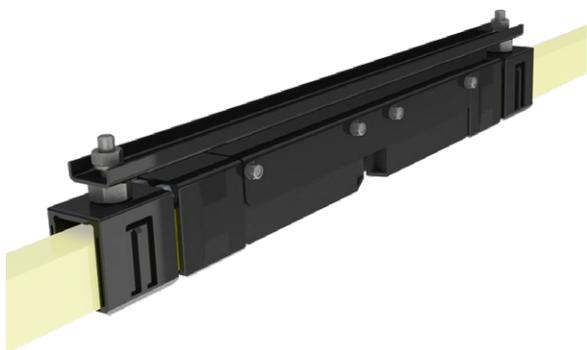
Lufttrennstellen werden zur galvanischen Abtrennung von Teilbereichen wie Wartungsstrecken eingesetzt, die getrennt eingespeist und abgeschaltet werden können. Pro Trennstelle sind 2 Lufttrennstellen in geeignetem Abstand zu montieren um eine Spannungsverschleppung über die Stromabnehmer zu vermeiden.
