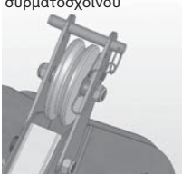
Θέση ασφαλείας κατά του αναπηδήματος του συρματόσχοινου
