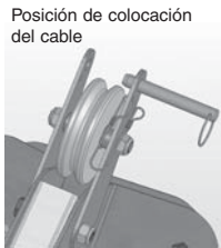
Posición de seguridad del cable (el cable no sale)
