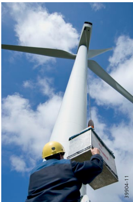
Bis 180 m Hakenweg für die Wartung von Windkraftanlagen
