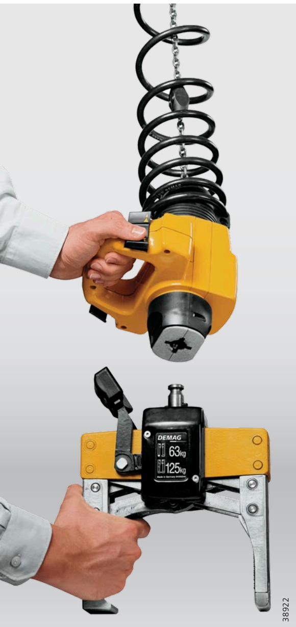
Die Schnellwechselkupplung als Schnittstelle
