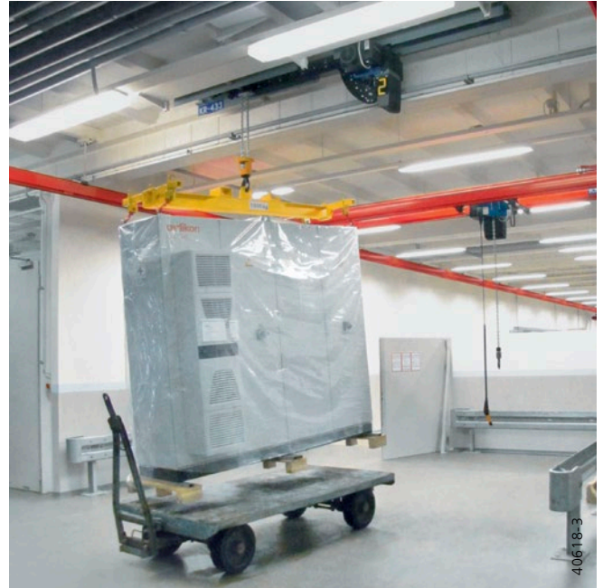
Kurze Katze KLDC mit verlängertem Hakenablauf (BigBag Katze)
