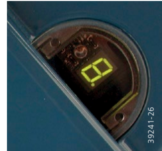
Anzeige für Betriebsstundenzähler und Betriebszustände
