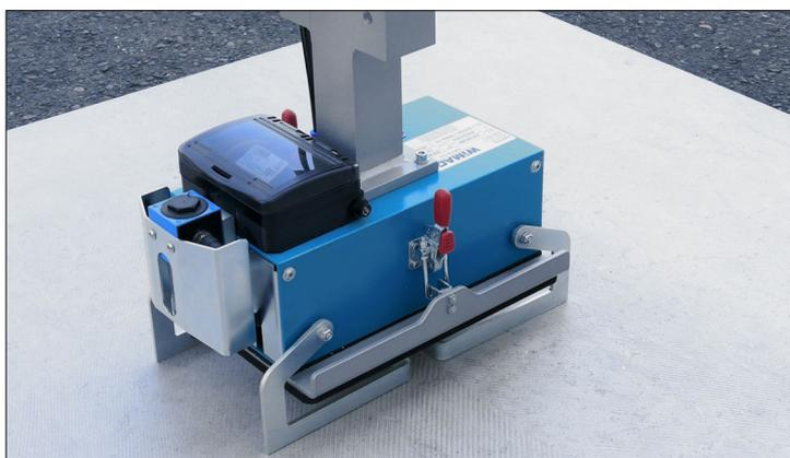
**Grundgerät:** Vakuumheber mit Zwei-Träger für den Zwei-Mann-Betrieb. Der Zwei-Träger ist in der Höhe von 500 bis 700 mm und in der Breite von 850 bis 1.250 mm verstellbar. Das Gerät ist serienmäßig mit Wasserabscheider und Manometer ausgestattet.
