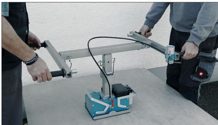
Alle glatten/rauen und luftundurchlässige Platten können mit dem Beta-Levator problemlos gehoben, transportiert und verlegt werden. Sofort nach dem Aufsetzen saugt sich der Levator fest.
