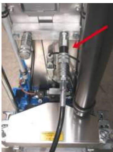
Foto 26: Verbindung der Tankleitung
