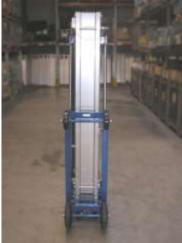
Foto 2: Transportgestell mit Masteinheit
