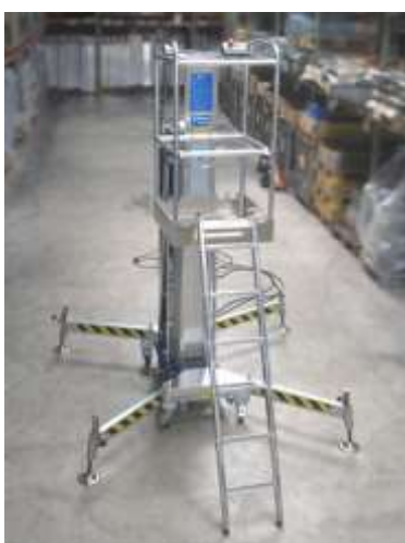
Foto 40: Fahrkorb Position "oben" mit Leiter
