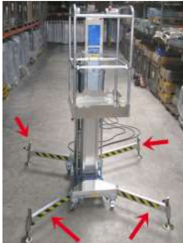
Foto 20: PHC 1000 EU mit vier gleichlangen Auslegern
