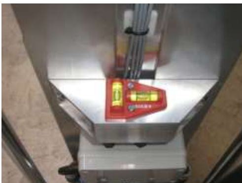
Foto 30: Wasserwaage an der Rückseite der Hubarbeitsbühne
