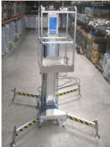
Foto 24: Mastseinheit mit Fahrkorb
