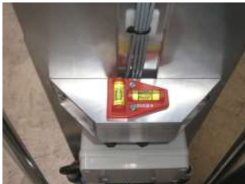
Foto 23: Wasserwaage an der Rückseite der Hubarbeitsbühne
