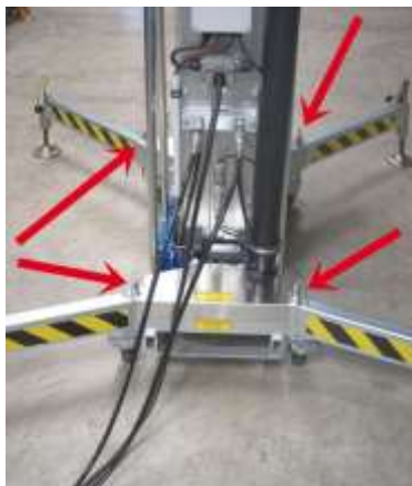
Foto 22: Sicherungsbolzen an den Auslegern
