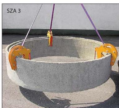
Die Schachtzange wird zum Transport und Versetzen von Schachtringen eingesetzt.
