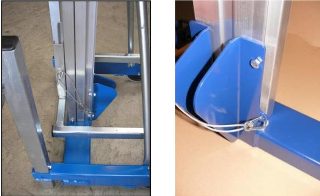
Lösen Sie nun die Flügelmutter an der Sicherungsschraube und entnehmen Sie die Sicherungsschraube aus der Lastgabel und dem Schlitten.
