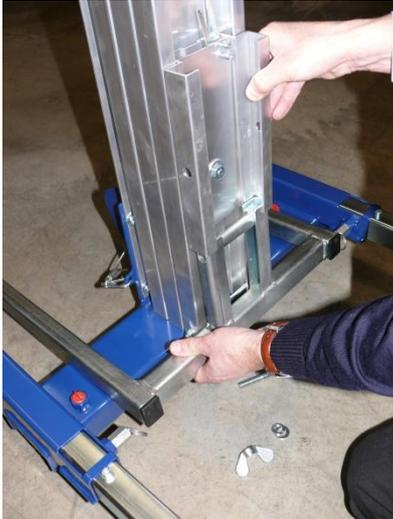
Ist die Lastgabel vom Schlitten getrennt, so hängen Sie den Schlitten vorsichtig wieder in das Drahtseil. Nun entfernen Sie mit beiden Händen die Lastgabel. Montieren Sie die Lastgabel wahlweise an der Ober- oder Unterseite des Schlittens und positionieren Sie die Sicherungsschraube wieder in dem Schlitten und der Lastgabel. Sichern Sie diese Verbindung mittels der Flügelmutter, der Unterlegscheibe und dem Federring.
