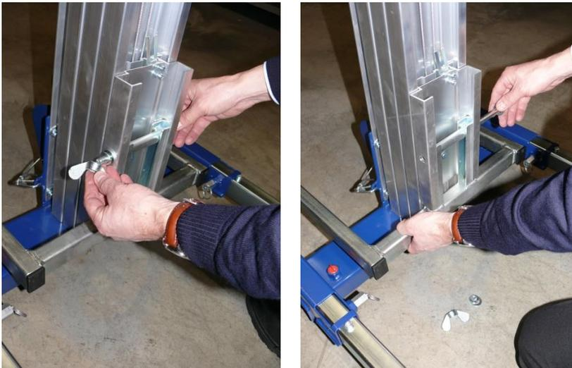
Ziehen Sie die Lastgabel mit der einen Hand aus dem Schlitten heraus, indem Sie den Schlitten vorsichtig mit der anderen Hand anheben.
