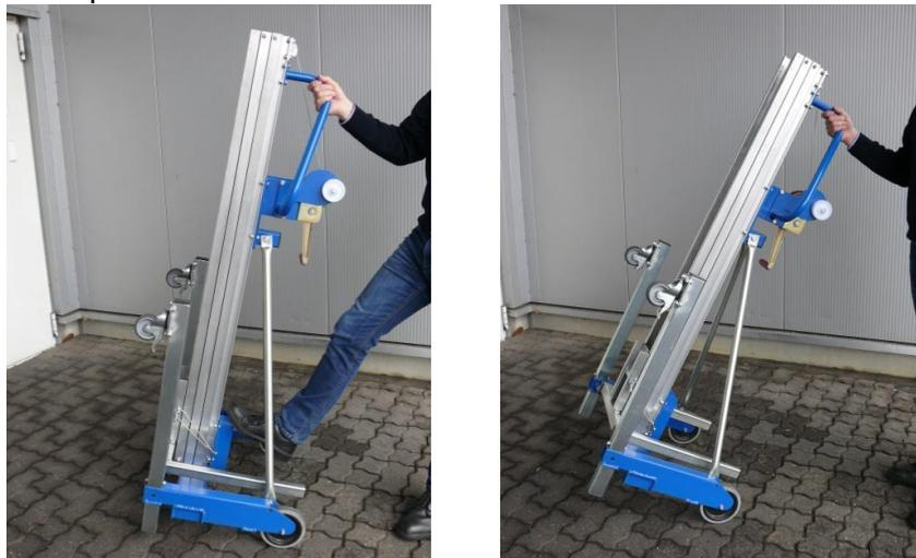
Fassen Sie den Lasten-Lift mit einer Hand an dem montierten Handgriff an, setzen einen Fuß gegen das Fahrgestell und kippen den Lasten-Lift LMJ 390 über die Transporträder nach hinten. Halten Sie hierbei den Lasten-Lift im Gleichgewicht. Der Lasten-Lift kann nun verschoben werden.
